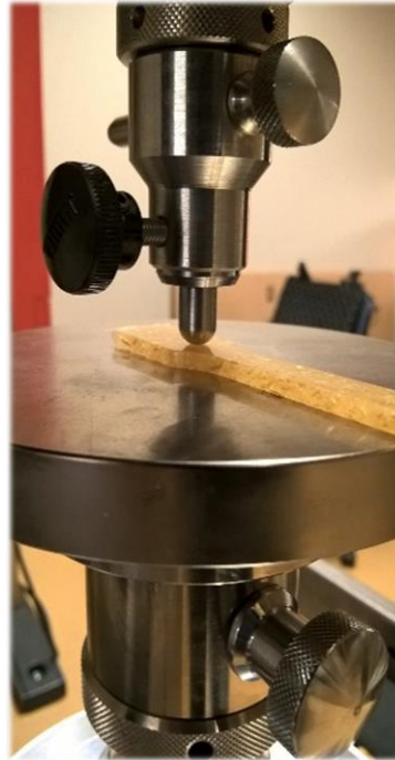
Laite viskoelastisten taivutusominaisuuksien mittaamiseen pienistä kappaleista
